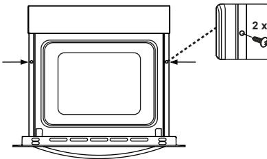
Ubacite rernu u ormarić tako što ćete je gurnuti napred. Otvorite vrata rerne i ubacite 2 šrafa u rupe koje su locirane na okviru rerne. Dok okvir proizvoda dodiruje drvenu površinu ormarića, zategnite šrafove.
