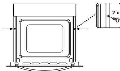
Pećnicu umetnite u kuhinjski ormarčić tako da ju gurate prema naprijed. Otvorite vrata pećnice i umetnite 2 vijke u otvore koji se nalaze na okviru pećnice. Kad okvir proizvoda dodirne drvenu površinu ormarića, zategnite vijke.
