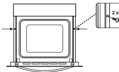
Pečico vstavite v ohišje tako, da jo potisnete naprej. Odprite vrata pečice in vstavite 2 vijaka v luknji na ogrodju pečice. Ko se ogrodje dotika lesene površine ohišja, zategnite vijaka.
