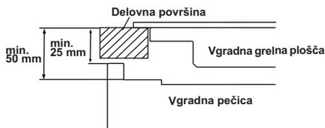
Če je pečica nameščena pod grelno ploščo, mora biti najmanjša razdalja med delovno površino in zgornjo ploščo pečice 50 mm in razdalja med delovno površino in vrhom upravljalne plošče najmanj 25 mm.
