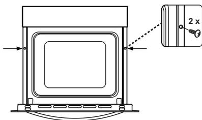
Ubacite rernu u ormaric tako što ćete je gurnuti napred. Otvorite vrata rerne i ubacite 2 šrafova u rupe koje su locirane na okviru rerne. Dok okvir proizvoda dodiruje drvenu površinu ormarića, zategnite šrafove.
