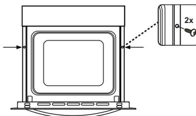
Troubu zasuňte do skříně. Otevřete dveře trouby a do otvorů v rámu trouby zasuňte 2 šrouby. Zatímco se rám produktu dotýká dřevěného povrchu skříně, šrouby utáhněte.
