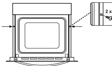
Vložte rúru do skrinky jej zasunutím smerom dopredu. Otvorte dvere rúry a vložte 2 skrutky do otvorov nachádzajúcich sa na ráme rúry. Zariadte, aby sa rám produktu dotýkal dreveného povrchu skrinky, a utiahnite skrutky.
