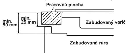
Ak rúru inštalujete pod varič, vzdialenosť medzi pracovným povrchom a horným panelom rúry musí byť minimálne 50 mm a vzdialenosť medzi pracovným povrchom a vrchom ovládacieho panela musí byť minimálne 25 mm.
