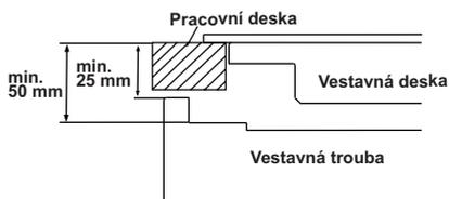
Je-li trouba nainstalovaná pod plotnou, vzdálenost mezi pracovní plochou a horním panelem trouby musí být minimálně 50 mm a vzdálenost mezi pracovní plochou a horní částí ovládacího panelu musí být minimálně 25 mm.
