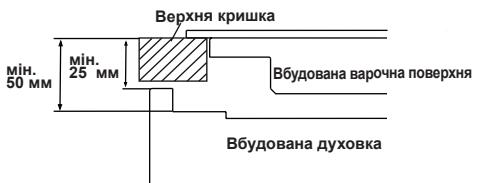
Якщо духовка встановлюється під варочною поверхнею, відстань від робочою поверхнею та духовкою має бути не менше ніж 50 мм, а між робочою поверхнею та верхом панелі керування — не менше ніж 25 мм.
