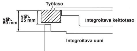
Jos uuni asennetaan liedin sisälle, työpöydän ja uunin yläpaneelin välissä on oltava vähintään 50 mm, ja etäisyyden työtason ja ohjauspaneelin yläosan välillä tulee olla vähintään 25 mm.
