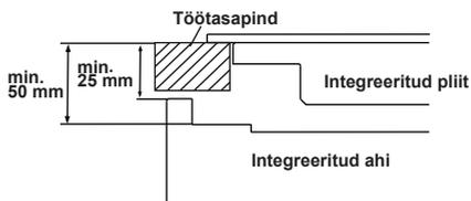
Kui ahi paigaldatakse pliidiplaadi alla, peab tööpinna ja ahju pealmispaneeli vahele jääma vähemalt 50 mm ning tööpinna ja juhtpaneeli pealispinna vahele vähemalt 25 mm vaba ruumi.
