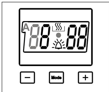
La minuterie doit être ajustée avant de commencer l'utilisation du four. Une fois le four sous tension, le symbole (A) et les trois "0" sur l'écran commenceront à clignoter. Pressez les touches (+) et (-) simultanément.
