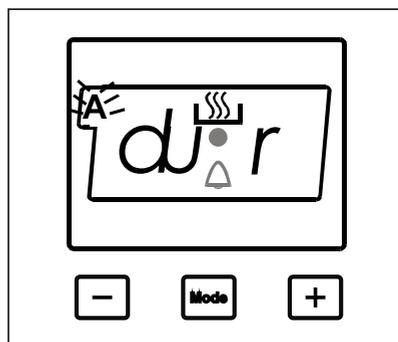
Cette fonction utilisée pour cuire durant la gamme de temps désirée. Les aliments à cuire sont placés dans le four. Le four est réglé sur la fonction de cuisson désirée. Le thermostat du four est ajusté à la température requise selon le plat à cuire. Gardez la touche MODE pressée jusqu'à ce que
