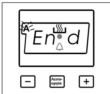
Η λειτουργία αυτή χρησιμοποιείται για ψήσιμο σύμφωνα με την επιθυμητή ώρα τερματισμού. Το φαγητό που πρόκειται να ψηθεί τοποθετείται μέσα στον φούρνο. Ο φούρνος ρυθμίζεται στην επιθυμητή λειτουργία ψησίματος. Ο θερμοστάτης του φούρνου ρυθμίζεται στο επιθυμητό επίπεδο ανάλογα με το γεύμα που πρόκειται να ψηθεί. Πατήστε επανειλημμένα το κουμπί MODE ώσπου να δείτε την ένδειξη “end” στην οθόνη του χρονοδιακόπτη, το σύμβολο (A) και η ώρα θα αρχίσουν να αναβοσβήνουν.
