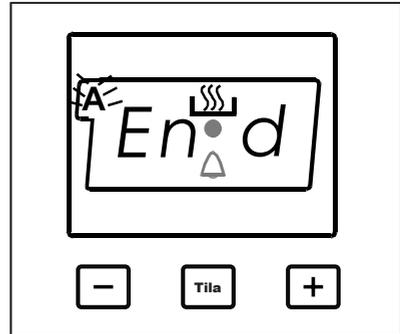
Tätä toimintoa käytetään kypsennykseen halutun ajan jälkeen määrätyn ajan. Kypsennettävä ruoka laitetaan uuniin. Uuniin asetetaan haluttu kypsennystoiminto. Uunin termostaatti asetetaan haluttuun lämpöön riippuen kypsennettävästä annoksesta.
