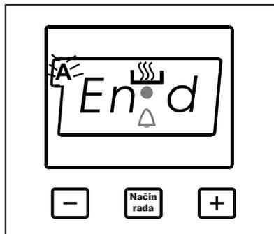
Nakon toga, nastavite pritiskati tipku MODE (način rada) sve dok na zaslonu mjerača vremena ne vidite "end" (kraj). Kad na zaslonu mjerača vremena vidite "end" (kraj), simbol (A) i trenutno vrijeme početi će treperiti zajedno s vremenom kuhanja. Podesite vrijeme završetka kuhanja hrane uz pomoć tipki (+) i (-) kad se mjerač vremena nalazi u ovom položaju. Nekoliko trenutaka nakon završetka podešavanja, na zaslonu će se pojaviti vrijeme i simbol (A) neprestano će svijetliti na zaslonu.
