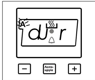
Η λειτουργία αυτή χρησιμοποιείται για ψήσιμο εντός του επιθυμητού χρονικού εύρους. Τα φαγητά που πρόκειται να ψηθούν τοποθετούνται μέσα στον φούρνο. Ο φούρνος ρυθμίζεται στην επιθυμητή λειτουργία ψησίματος. Ο θερμοστάτης του φούρνου ρυθμίζεται στο επιθυμητό επίπεδο ανάλογα με το γεύμα που πρόκειται να ψηθεί. Πατήστε επανειλημμένα το κουμπί MODE ώσπου να δείτε την ένδειξη "stop" στην οθόνη του χρονοδιακόπτη. Όταν
