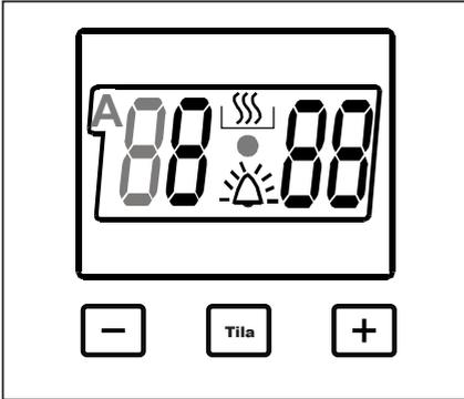
Aika on säädettävä ennen uunin käytön aloittamista. Kun virta uuniin on kytketty päälle, merkki (A) ja kolme "0"-merkkiä vilkkuvat näytöllä. Paina (+) ja (-) -painikkeita yhtä aikaa.
