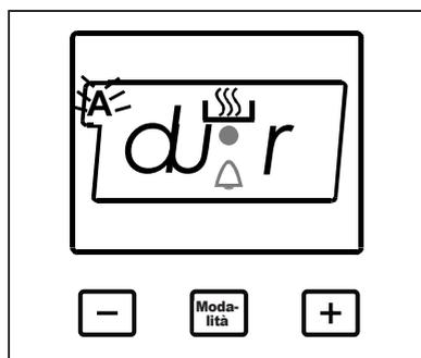
Questa funzione viene usata per cuocere dopo un certo periodo di tempo, all'interno di una certa durata. Gli alimenti da cuocere vengono messi nel forno. Il forno viene regolato sulla funzione di cottura desiderata. Il termostato del forno viene regolato sul grado desiderato a seconda del piatto da cuocere.
