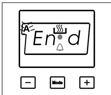
Cette fonction est utilisée pour cuire jusqu'à une heure prédéfinie. Les aliments à cuire sont placés dans le four. Le four est réglé sur la fonction de cuisson désirée. Le thermostat du four est ajusté à la température requise selon le plat à cuire. En pressant la touche MODE jusqu'à ce que "end" (fin) s'affiche sur l'écran de minuterie, le symbole (A) et l'heure commenceront à clignoter.
