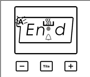
Tätä toimintoa käytetään kypsentaessä haluttuun lopetusaikaan saakka. Kypsennettävä ruoka laitetaan uuniin. Uuniin asetetaan haluttu kypsennys-toiminto. Uunin termostaatti asetetaan haluttuun lämpöön riippuen kypsennetävstä annoksesta. Paina MODE-painiketta, kunnes näet ajastinnäytöllä "end". Tämän jälkeen merkki (A) ja kellonaika alkavat vilkkua.
