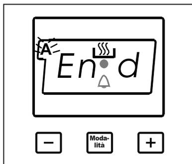
Questa funzione viene usata per cuocere nell'intervallo di completamento desiderato. Gli alimenti da cuocere vengono messi nel forno. Il forno viene regolato sulla funzione di cottura desiderata. Il termostato del forno viene regolato sul grado desiderato a seconda del piatto da cuocere. Tenere premuto il pulsante MODE fino a che non viene visualizzato "Fine" sullo schermo, il simbolo (A) e l'ora del giorno iniziano a lampeggiare.
