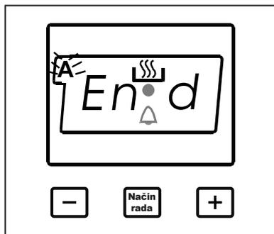
Ova funkcija koristi se za kuhanje sa željenim završetkom kuhanja. Hrana koju je potrebno skuhati stavi se u pećnicu. Pećnica se podesi na željenu funkciju kuhanja. Termostat pećnice podesi se na željeni stupanj ovisno o jelu kojeg je potrebno kuhati. Nastavite pritiskati tipku MODE (način rada) sve dok na zaslonu mjerača vremena ne vidite "end" (kraj). Nakon toga, simbol (A) i vrijeme početak će treperiti.
