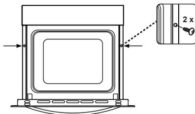
Pećnicu umetnite u kuhinjski ormarić tako da ju gurate prema naprijed. Otvorite vrata pećnice i umetnite 2 vijka u otvore koji se nalaze na okviru pećnice. Kad okvir proizvoda dodirne drvenu površinu ormarića, zategnite vijke.
