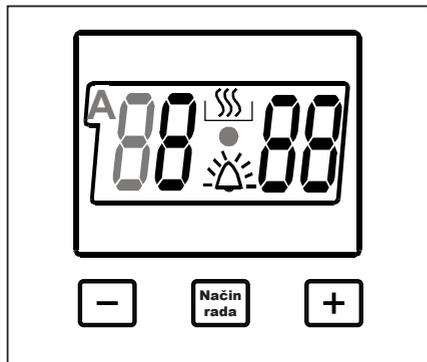
Vrijeme je potrebno podesiti prije početka korištenja pećnice. Nakon priključenja pećnice na struju, na zaslonu će početi treperiti simbol (A) i tri "0". Istovremeno pritisnite tipke (+) i (-).
