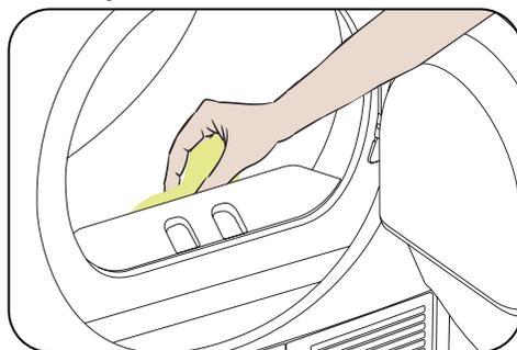
No interior da máquina, existem sensores de humidade que detetam se a roupa está ou não seca.
