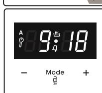
Коли на таймері буде нуль, духовна шафа вимкнеться та пролунає звуковий сигнал. Загориться символ “**A**” Поверніть обидві кнопки керування на положення “**0**” і натисніть будь-яку клавішу на таймері для того, щоб зупинити попереджувальний звуковий сигнал. Затисніть кнопку “**MODE**” протягом 2 секунд, зникне символ “**A**” і таймер повернеться знову в MODE самостійного налаштування.
