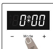
1. Затисніть кнопку "MODE" на 2 секунди задля вимкнення блокування кнопок поки не загориться крапка посередині екрану.
